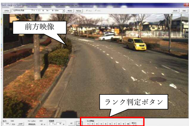
図-6 測定車B ひび割れ解読イメージ
