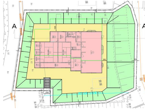
図-7 法面による設計の典型例
