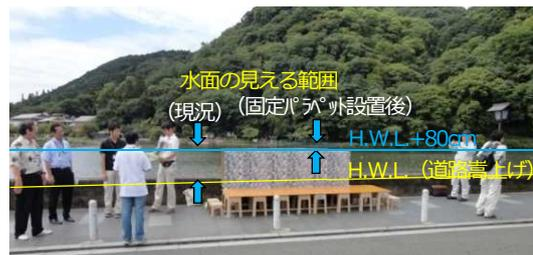
図5-3 模型を用いた景観への影響確認
