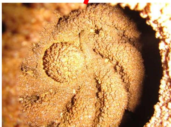
写真-1 エフロが付着したポンプの羽根車
