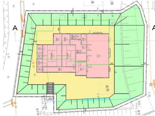
図-7 法面による設計の典型例
