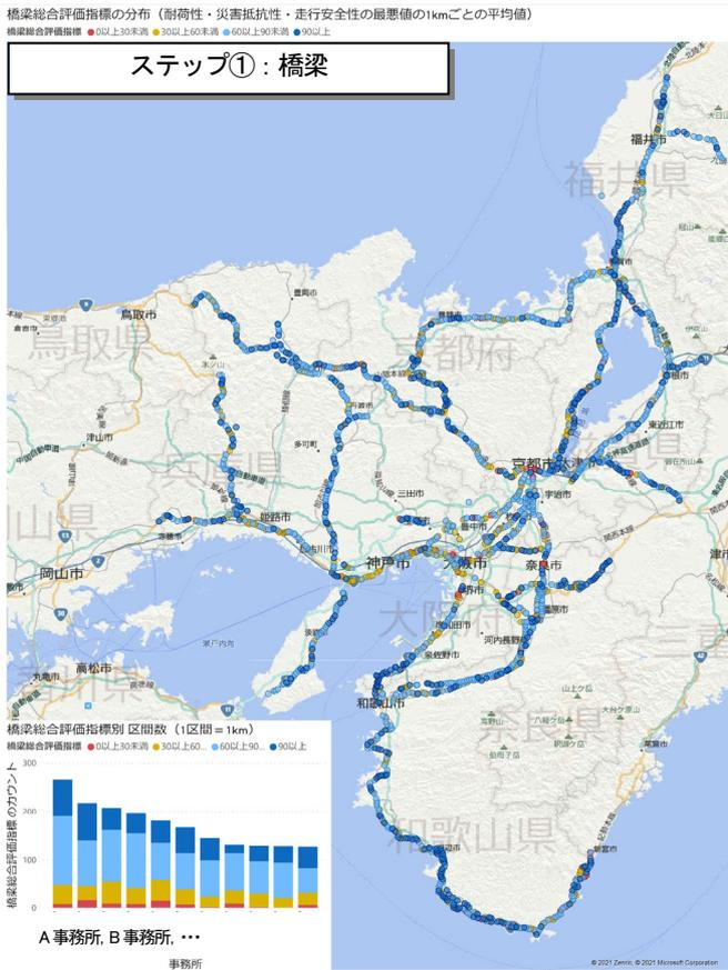
図-7 橋梁の健全性評価結果
