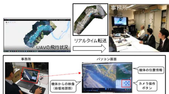
図-7 UAVと遠隔地間での映像共有
