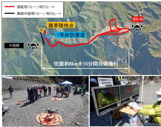
図-5 上; UAVの飛行ルート、下; 離発着地点と地上局
