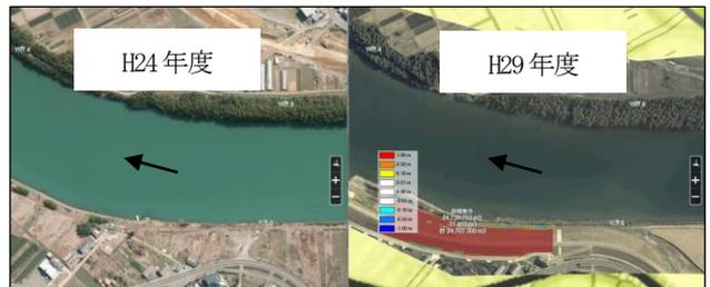
図-7 解析例：2時期のDTMの差分解析
