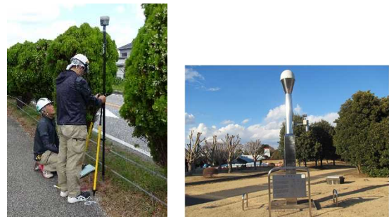
写真-8 GNSS測量機及び電子基準点
