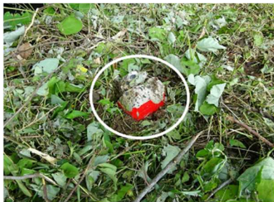
写真-2 損傷した境界杭
