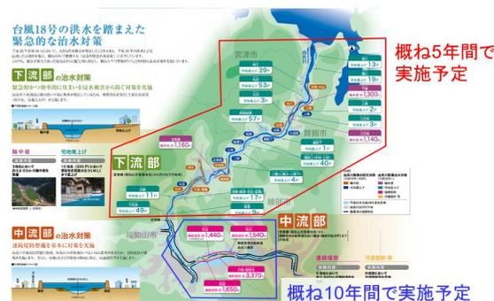
図-2 由良川緊急治水対策の概要
