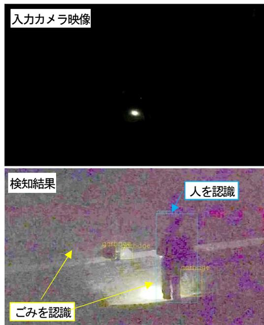
図4-8 ガンマ補正後の検知結果
