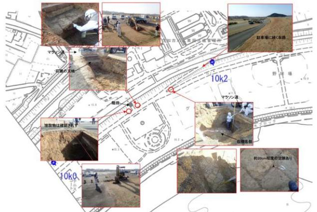
図-11 令和2年度高水敷試験掘結果
