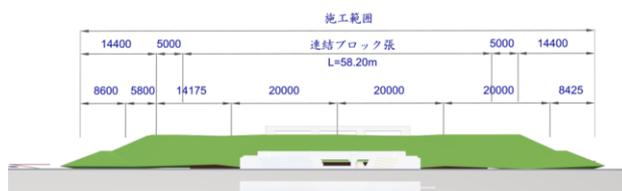
図-12 3dsMAXで作成した縦断面図
