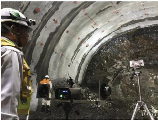
写真-2 自作した音響システム
