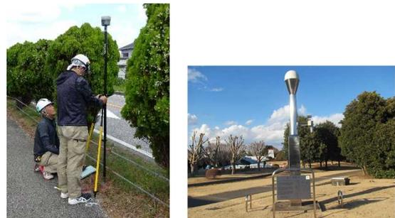
写真-8 GNSS測量機及び電子基準点
