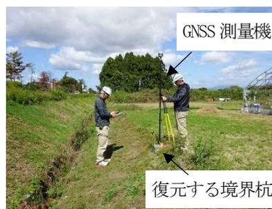
写真-9 GNSS測量機による復元作業
