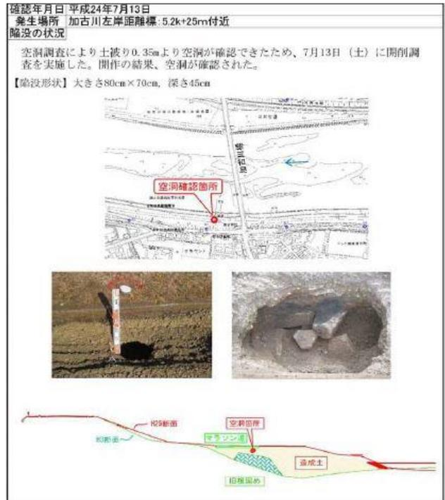
図-13 加古川左岸 5.2k 高水敷陥没状況
