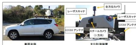
図6 地上レーザ計測
