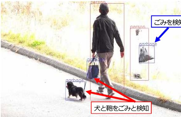
図44 検知システムの誤検知
