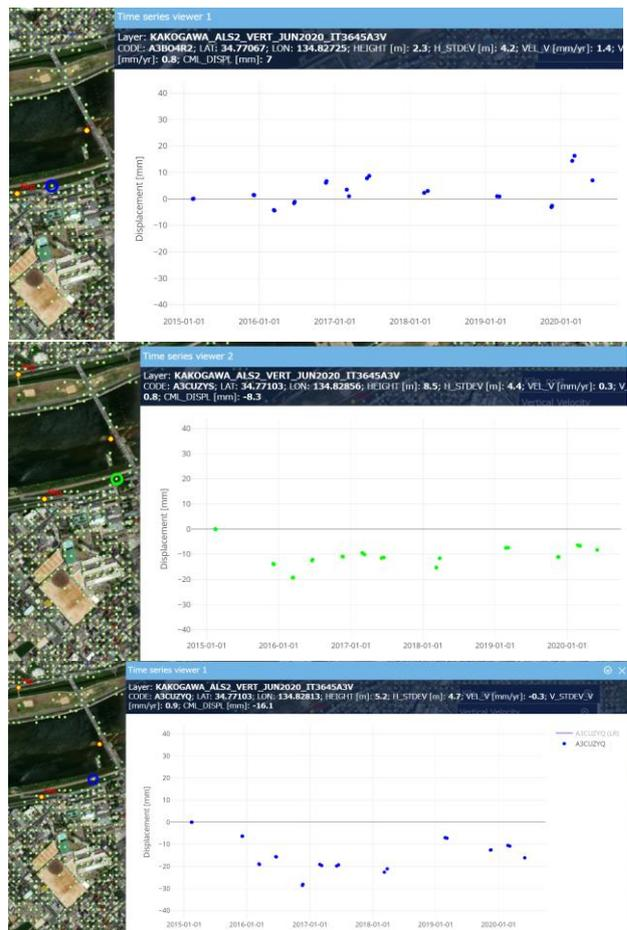
図-14 加古川左岸 5.2k 付近 SAR 画像分析結果
