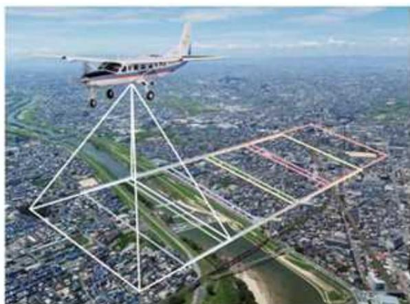
図-2 空中写真測量のイメージ<sup>2)</sup>
