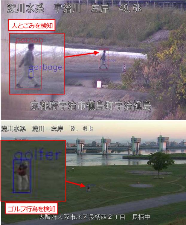
図4-3 CCTV映像の検知結果
