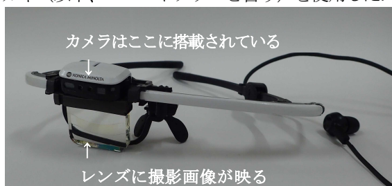
写真-1 リモート検尺に使用したスマートグラス
