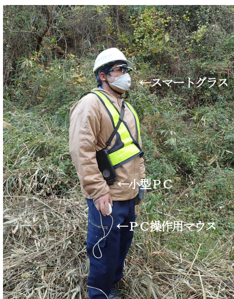
写真-2 リモート撮影器具の装備状況
