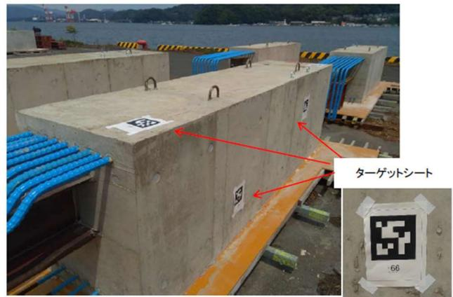
図- 18 計測時梁ブロック
