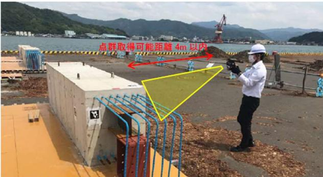
図- 20 3 次元スキャナーによる計測状況
