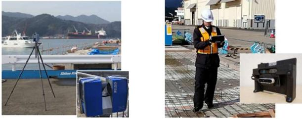
据置型 3 次元レーザースキャナー FARO（左）
