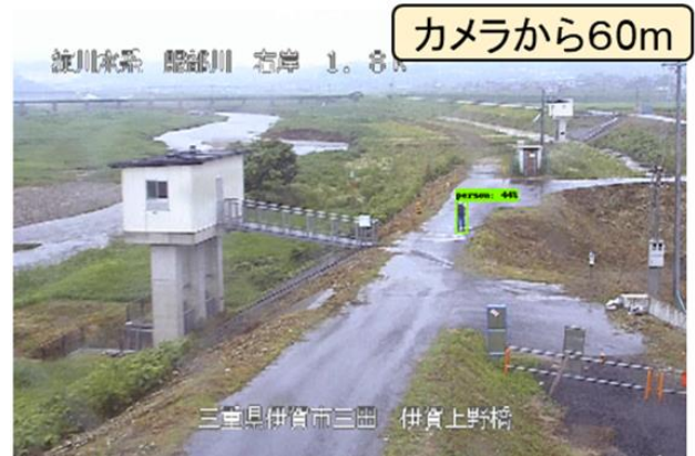
写真5-3 例: EfficientDetモデルによる認識
