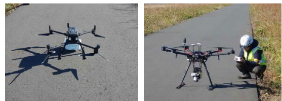
図-6 使用した計測機器 (グリーンレーザー測距装置及UAV機体)
