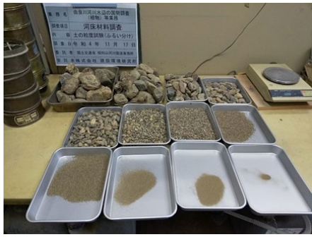
図-7 粒度分析 ふるい分け試験
