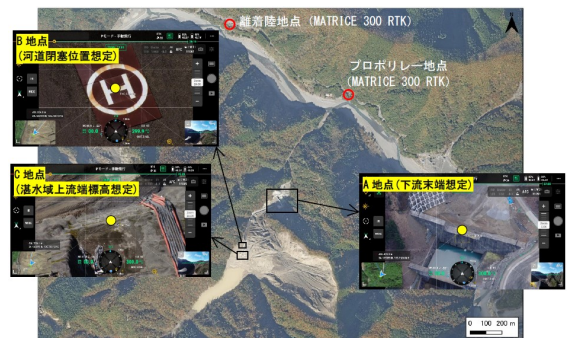
図 8 レーザ距離計による河道閉塞地点等の計測
