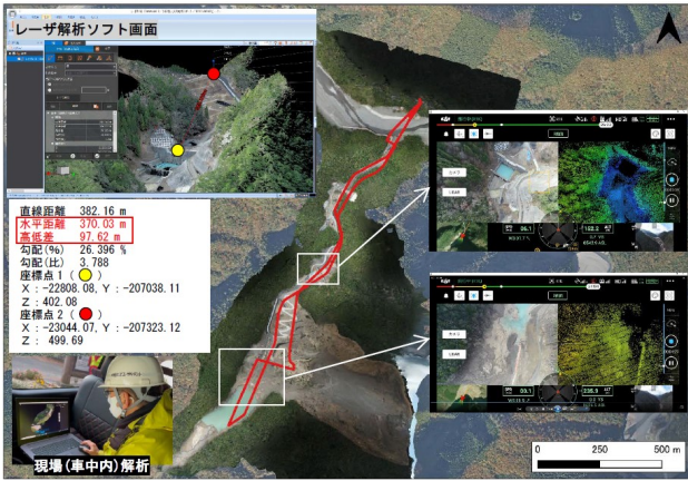
図9 レーザ計測による点群データの取得
