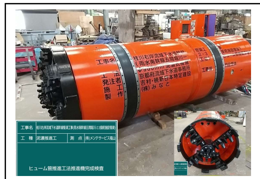
写真-7 推進工掘削機
