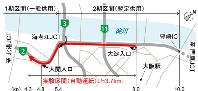
図-1 阪神高速淀川左岸線 (西行) における実験区間
