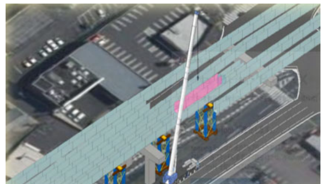
図-2 3次元データを用いた施工イメージ
