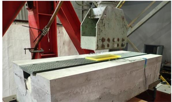
図-8 繰り返し载荷試験実施状況
