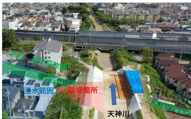
写真-1 天井川区間(手前は破堤箇所)
