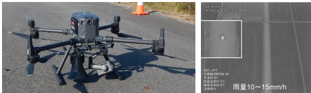
図-3 検証用ドローンと取得される赤外線画像
