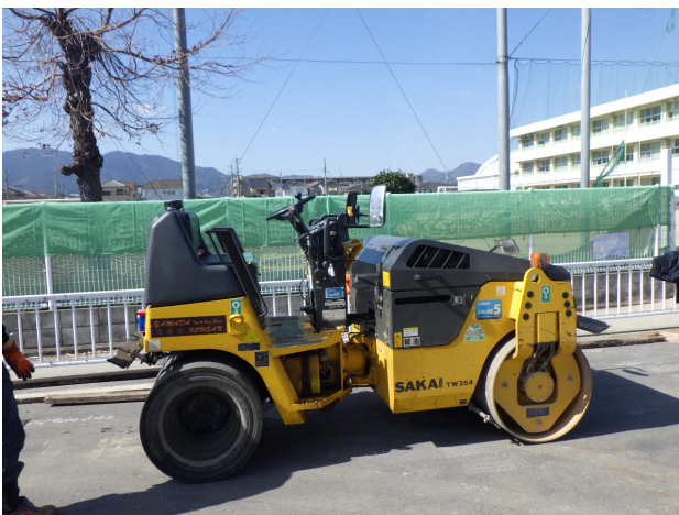
写真5 使用機材 コンバインド式振動ローラ
