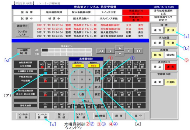
図－2 水噴霧設備の操作画面
