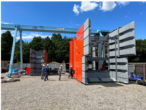
図-11 オープンシールド機仮組立
