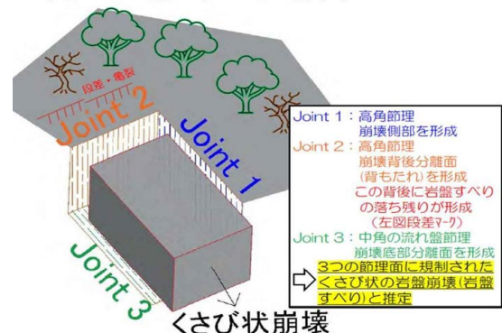
図-5 崩壊のメカニズム(模式図)
