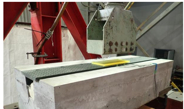
図-8 繰り返し載荷試験実施状況
