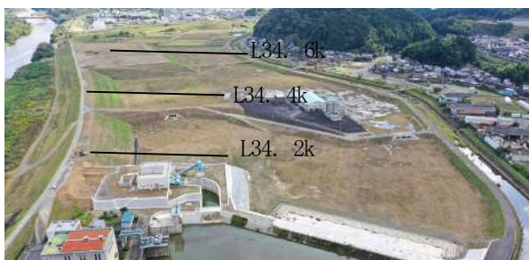
図-8 荒河調節池 安定照査検討断面
