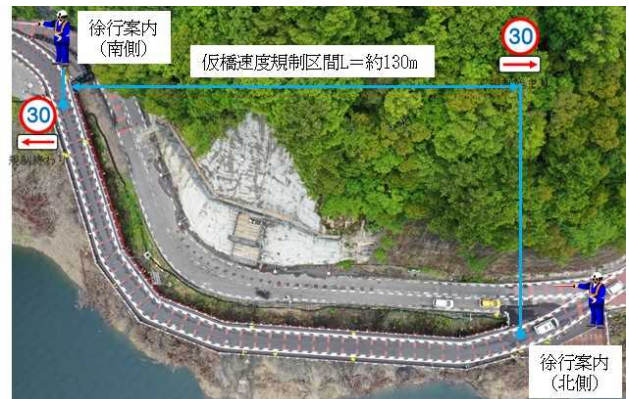
図-7 CASE③ 仮橋入口の交通誘導警備員配置
