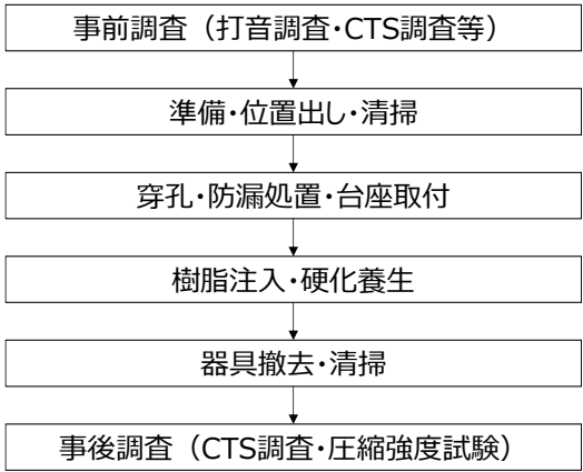
図-7 施工のフロー
