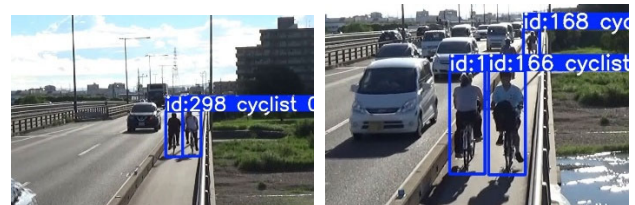
図-10 離隔が小さいすれ違いの例
