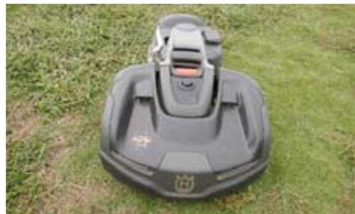
図-1 ロボット除草機の外観
