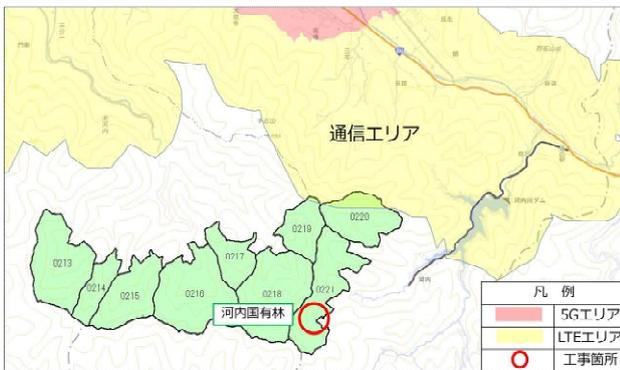
図-1 モバイル通信可能エリア<sup>1)</sup>と施工位置
