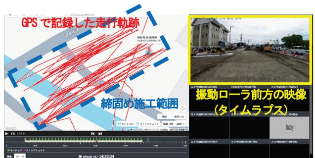
図-12 クラウド録画カメラ (Safie Pocket2 Plus) の撮影映像とGPSで記録した重機の走行軌跡
