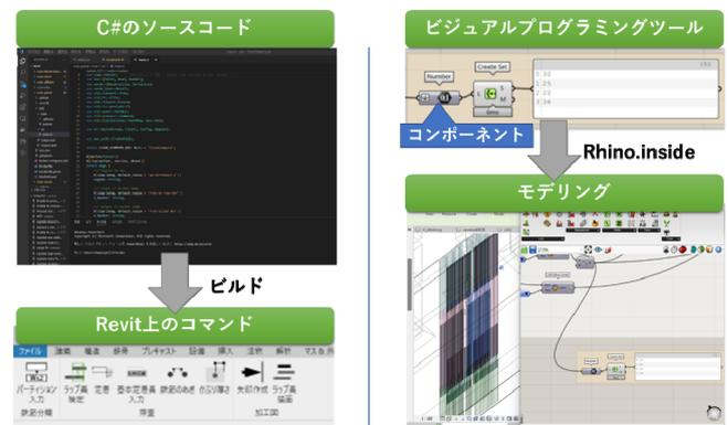
図-3 開発ツールとそのアウトプットの関係図
