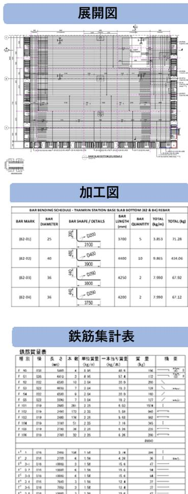
図-1 配筋施工図の具体例
