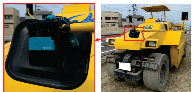
図-11 クラウド録画カメラ (Safie Pocket2 Plus) の取付状況
