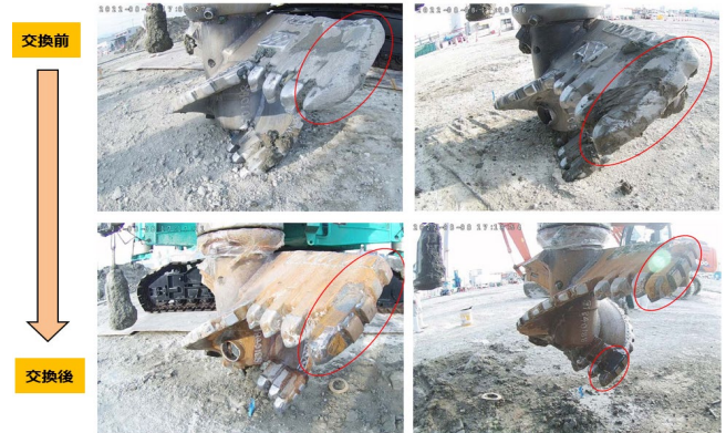
写真-6 攪拌ビットの交換前後
