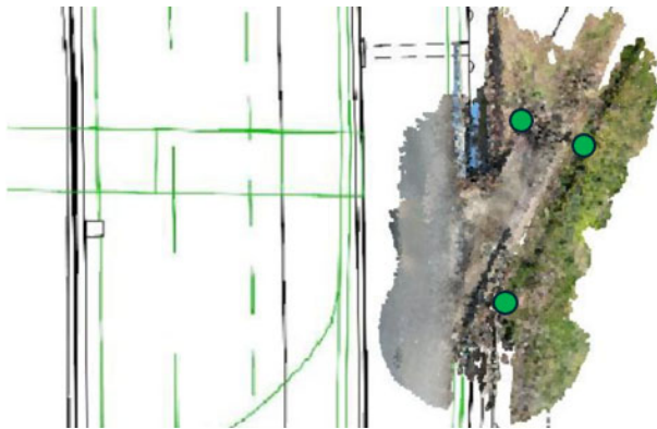
図-17 多項式1によるジオリファレンスの結果
