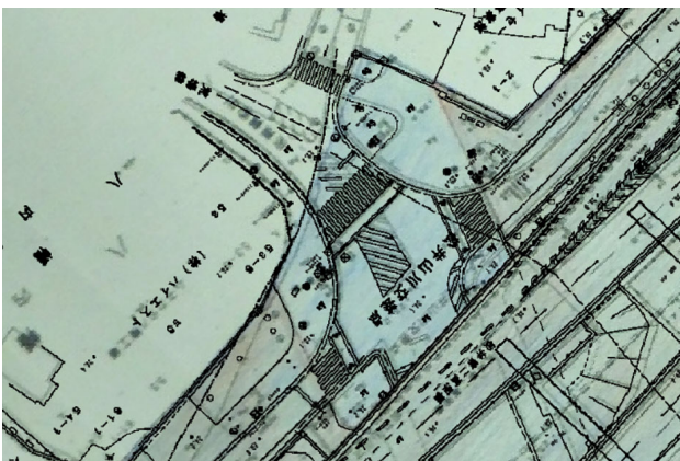
図-13 同拡大表示 4点指定して重ね合わせたが、比較的正確に区域変更範囲を確認できる
