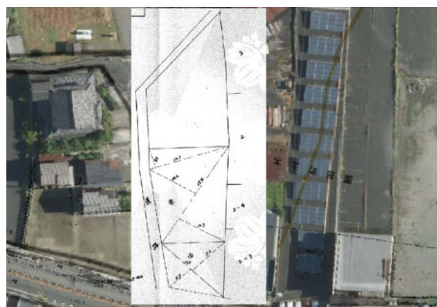
図-10 座標の無い地積測量図の重ね合わせ例
