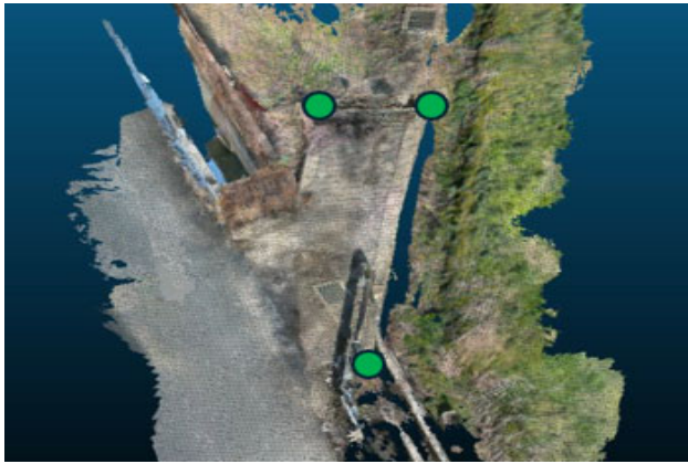
図-16 LiDARでスキャンしたデータをジオリファレンス機能にて附図の対応するポイントを指定して地図上に表示する（コンクリート擁壁の角3点）
