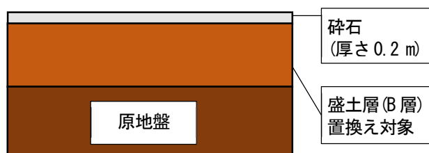
図-10 施工ヤードの断面
