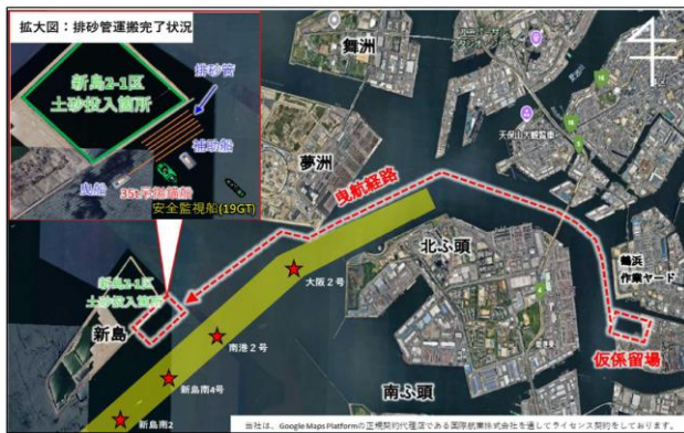
図-6 排砂管曳航経路
