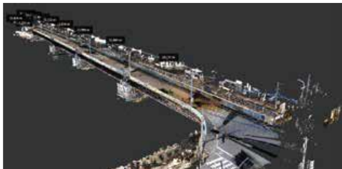
図-7 現況測量図(3Dスキャン)
