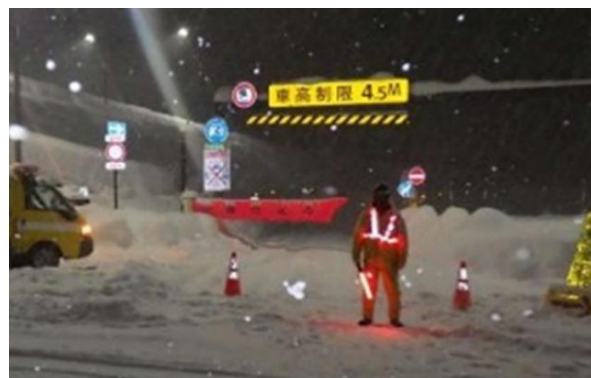
図-6 九頭竜ICにおけるエア遮断機の稼働状況
