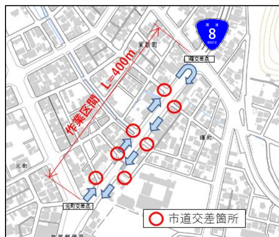
図-9 スクラム除雪作業区間（敦賀市）
