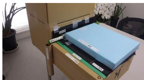
写真-2 床版防水の模型
