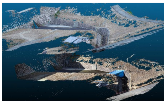
図-6 位置合わせ前の点群データの比較(Cloud Compare)(キャプチャ画像)
