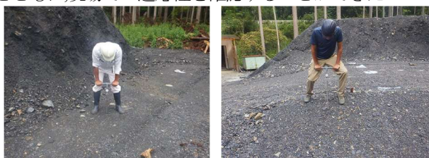
図-13 降雨後の盛土強度確認の写真
