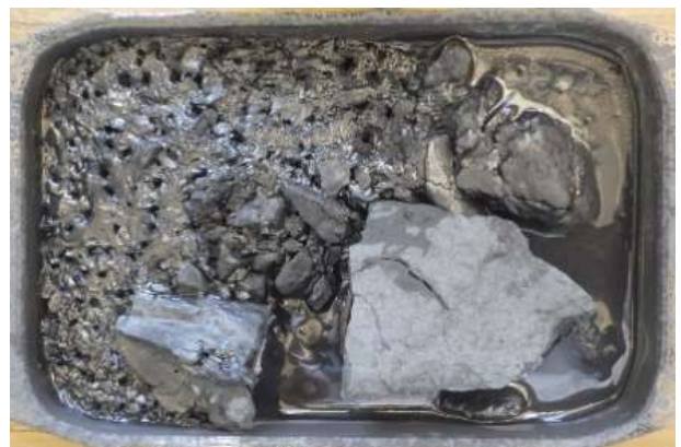
図-9 簡易浸水膨張試験の結果（上：前、下：後）
