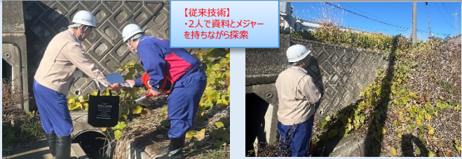
従来技術(境界確定図による目視確認)による杭探索状況
