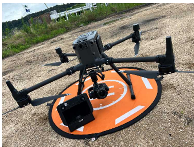
出来形計測 (ドローン)
