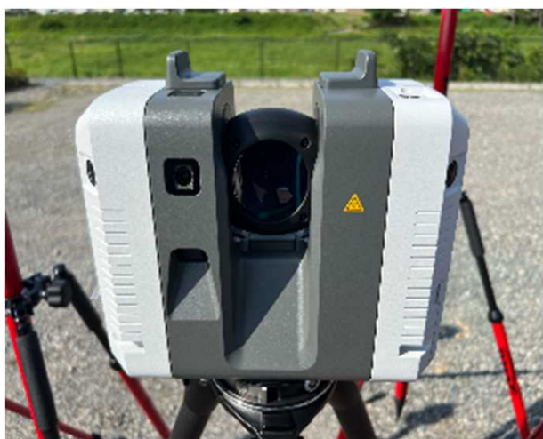
起工測量 (レーザースキャナー)
