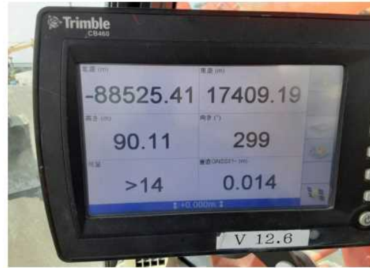
西側GNSS基準局設置 (E-タ-座標地確認)
