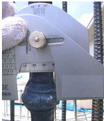
（従来）SYゲージによる計測
