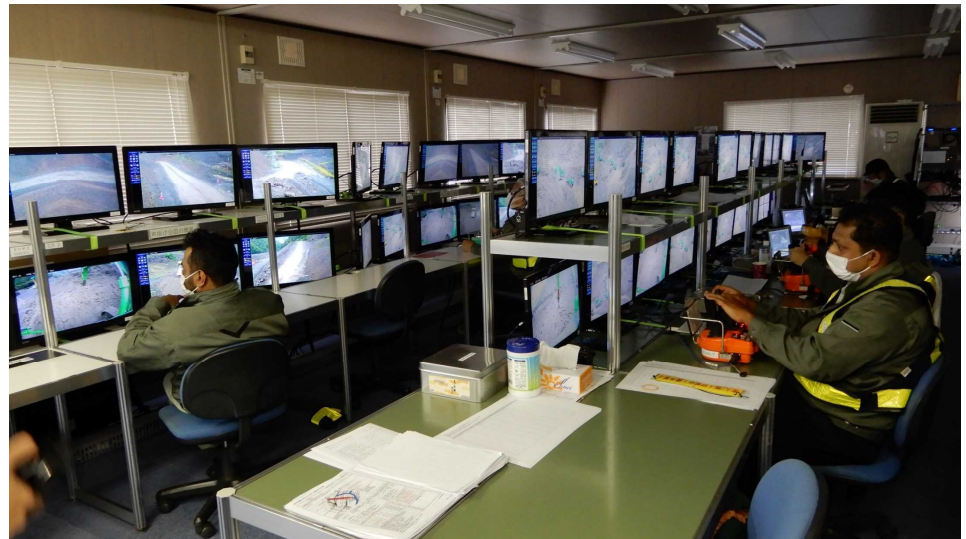
操作室内から遠隔操作
