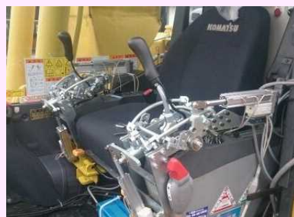
サロゲート(後付けの遠隔操作装置) 遠隔操作と搭乗操作の切替が瞬時に可能
