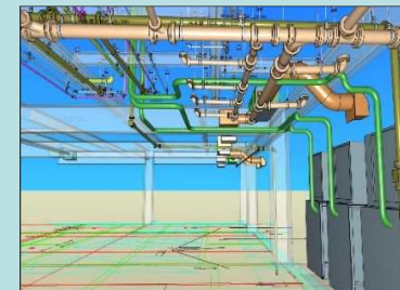
配管取合いやメンテナンススペースを確認
