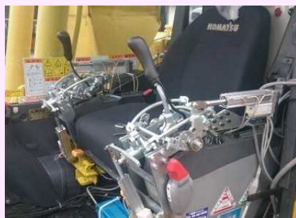
サロゲート(後付けの遠隔操作装置) 遠隔操作と搭乗操作の切替が可能
