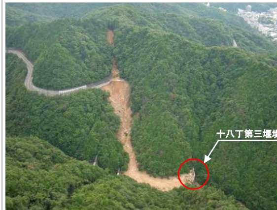
十八丁第三堰堤 : 約9,000m 3 の土砂を捕捉 (ダンプトラック1,800台分)
