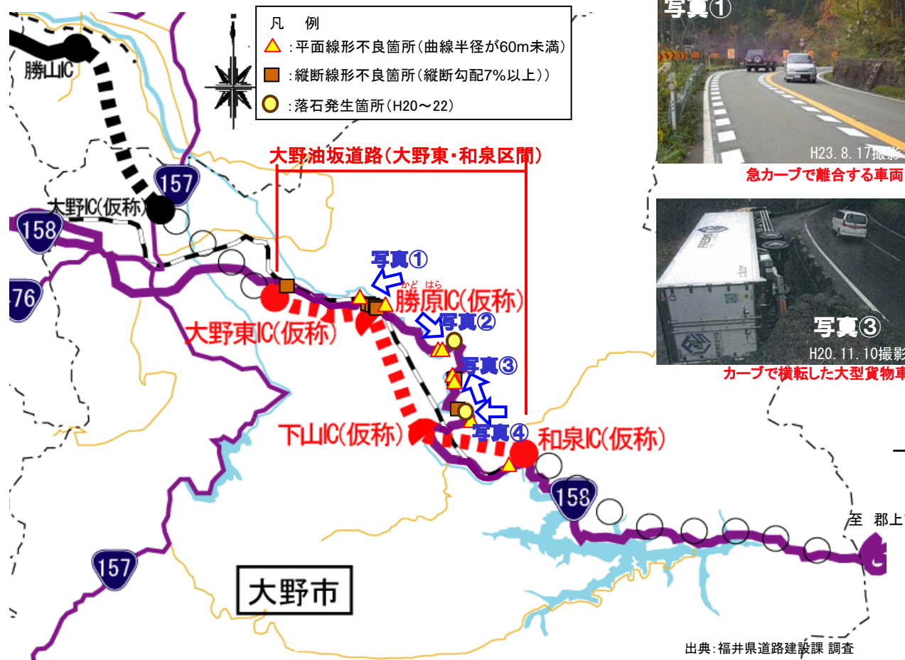
■ 一般国道158号 線形不良箇所及び落石発生箇所
