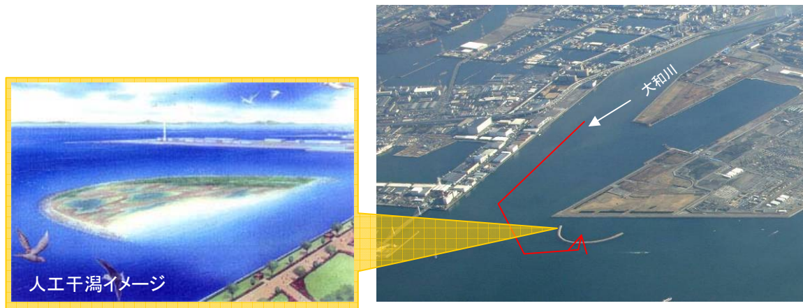
図 25 河口部掘削と人工干潟事業との連携によるコスト縮減策
