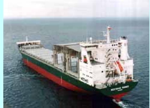
寄港実績 (R岸壁) を有する紙・パルプ、製材運搬用フル オープンハッチ船 {45,000DWT超、最大喫水11.8m}
