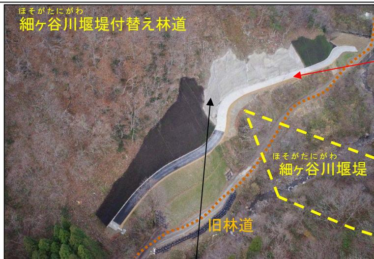
堰堤高が高く、現道を寸断するため回路(付替え林道)が必要。
