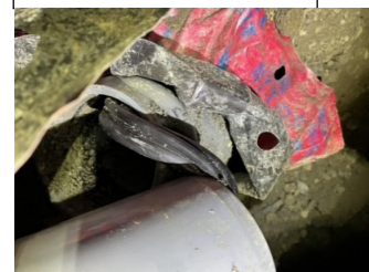
事故状況写真④ 破損した地下埋設管(塩ビ管φ75)
