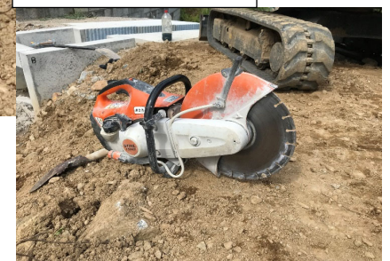
使用していたエンジンカッター
