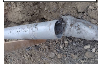
事故状況写真④ 破損した地下埋設管(塩ビ管φ75)
