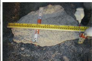
肌落ちした岩片 長さ 80cm 幅 50cm 厚さ 20cm
